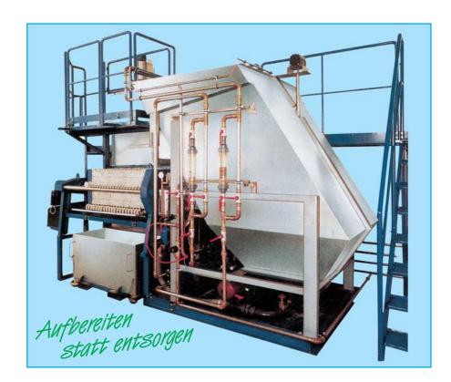
Dort wird über ein Vordosiergerät (6) automatisch die erforderliche Menge vom Aufbereitungsprodukt zudosiert und durch das Hochleistungsrührwerk (7) intensiv vermischt. Das so behandelte Schmutzwasser gelangt über eine Verbindungsleitung dann anschlie-ßend in den Schnellschrägklärer.
